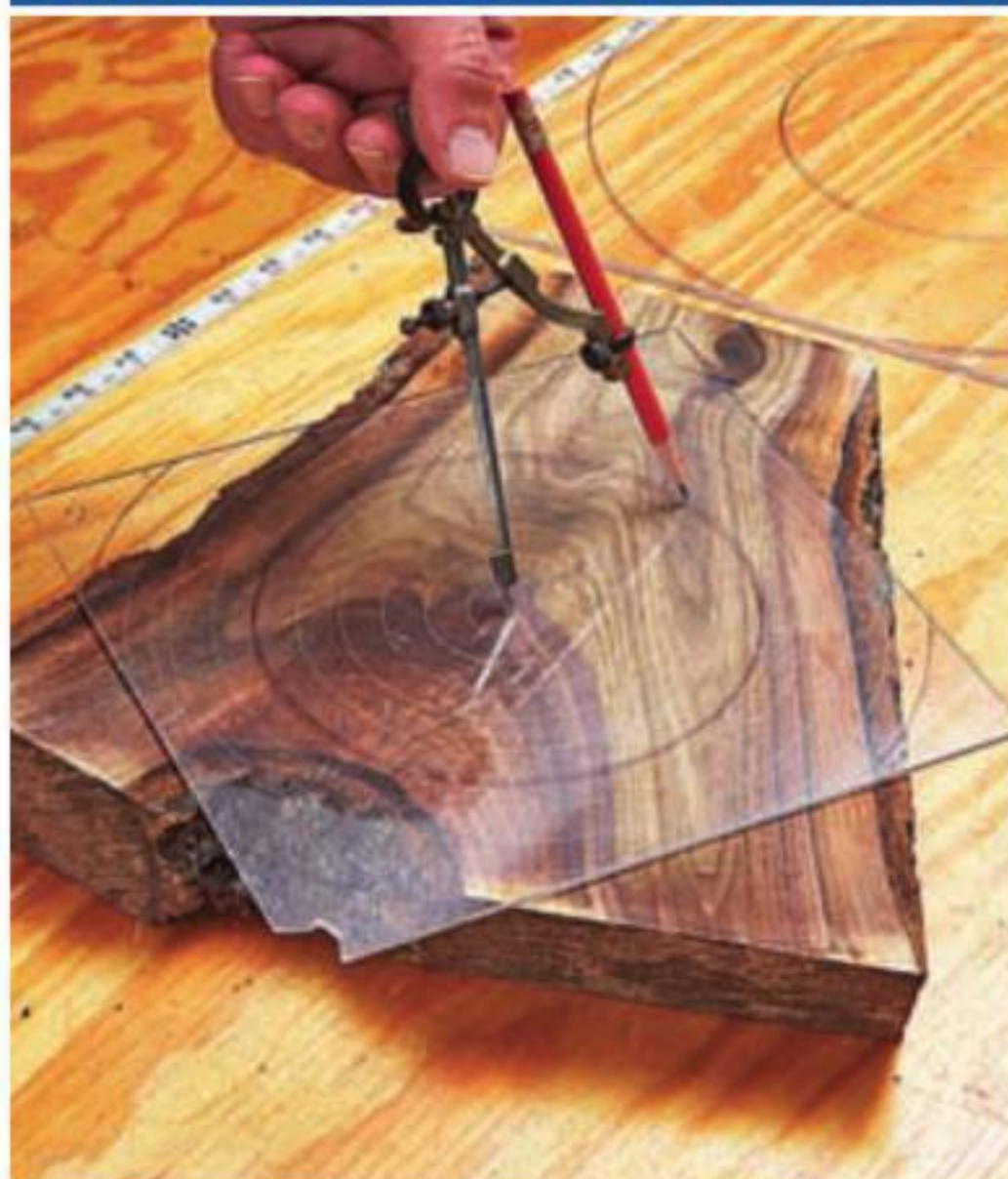
Кусок прозрачного оргстекла с концентрическими кругами дает возможность выбрать красивый участок и настроить циркуль для разметки заготовки.
