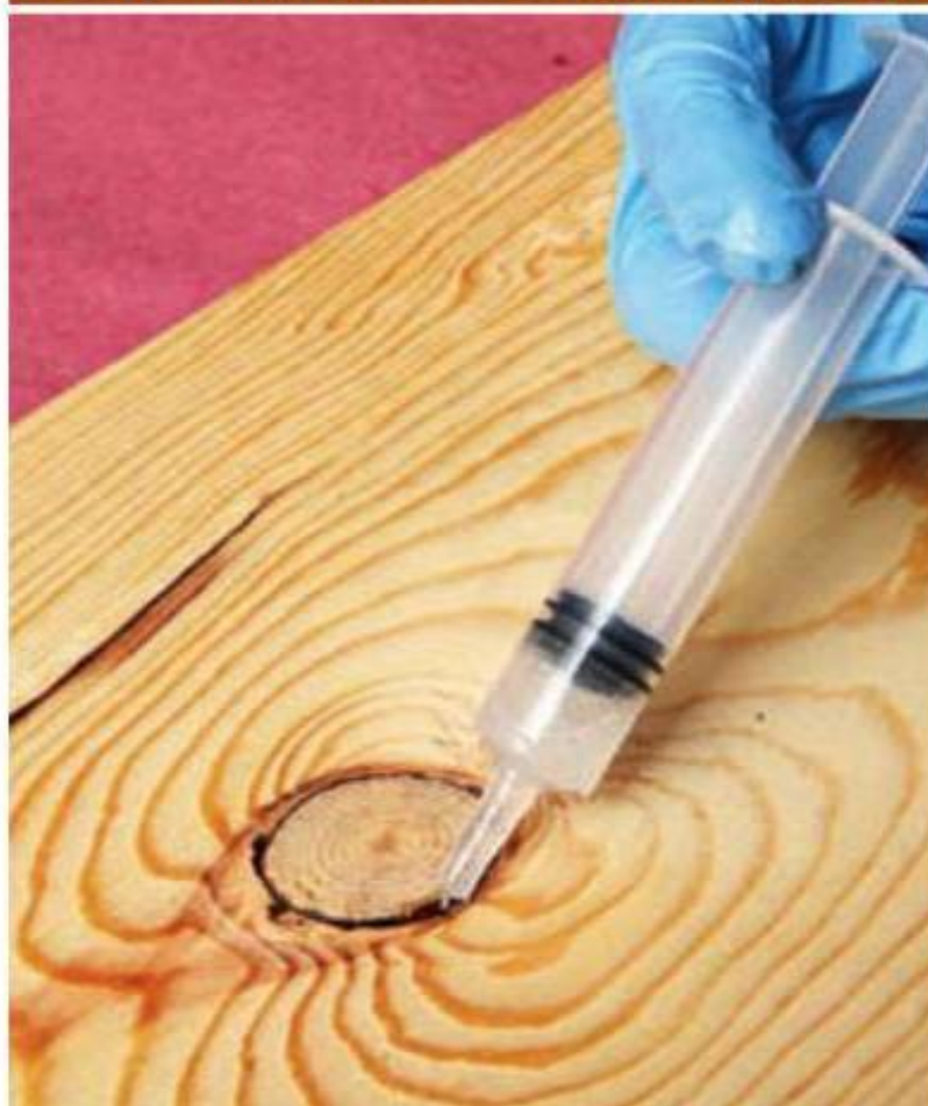
Небольшие зазоры вокруг сросшихся сучков иногда удается заполнить эпоксидным клеем с помощью пластикового шприца.
