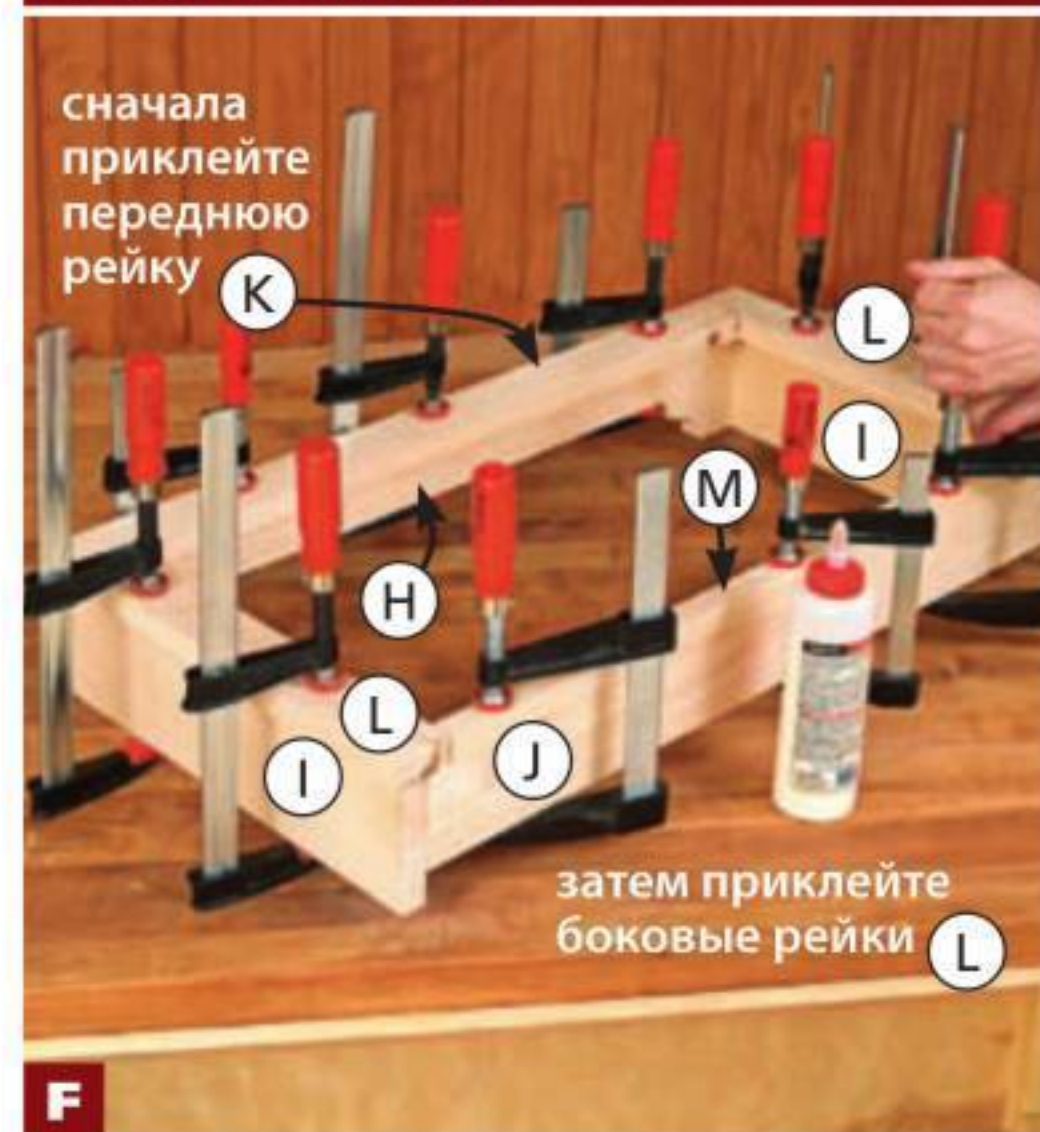
F Выровняйте переднюю рейку K посередине ширины цокольного основания H/I/J, выдвинув ее на 10 мм. Затем приклейте на место остальные детали цокольной рамы.
