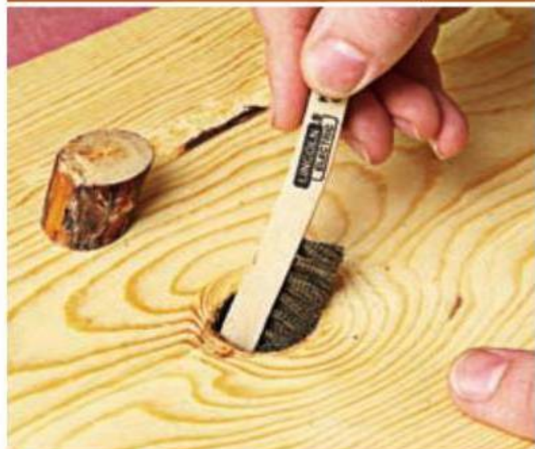
Удалив сучок, очистите его и отверстие от остатков коры и других загрязнений щеткой из латунной проволоки
