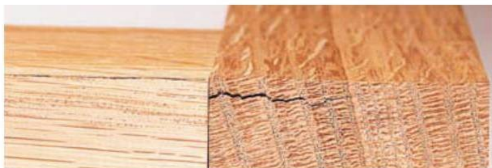
Подгоните шипы к гнездам, чтобы они вставлялись без усилия. Этот шип был слишком толстым, и тонкая стенка гнезда треснула.
