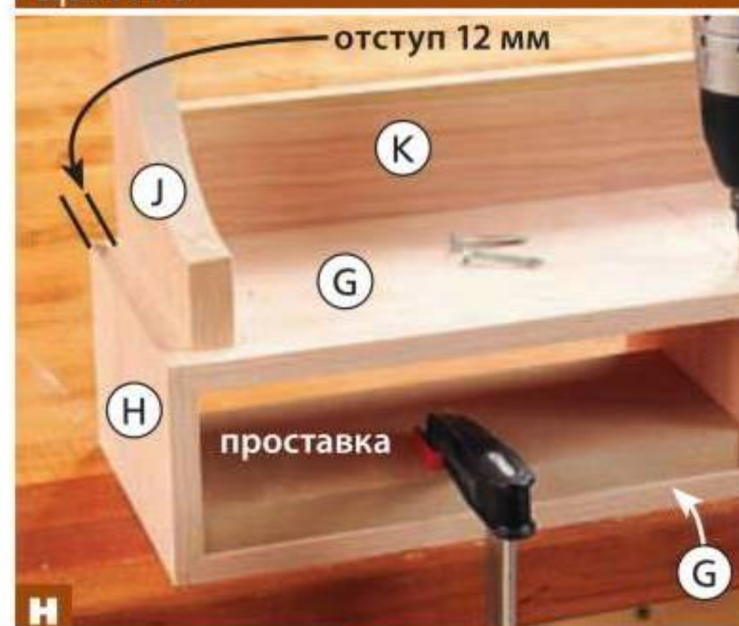
Две одинаковые проставки, между которыми образуется 12-миллиметровый зазор, удерживают перегородку I под прямым углом в центре корпуса, пока вы вворачиваете шурупы.
