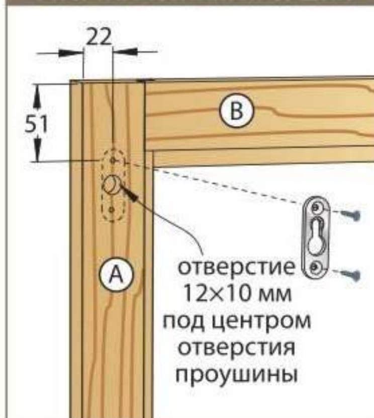
РИС. 1А. МОНТАЖ ПРОУШИН
