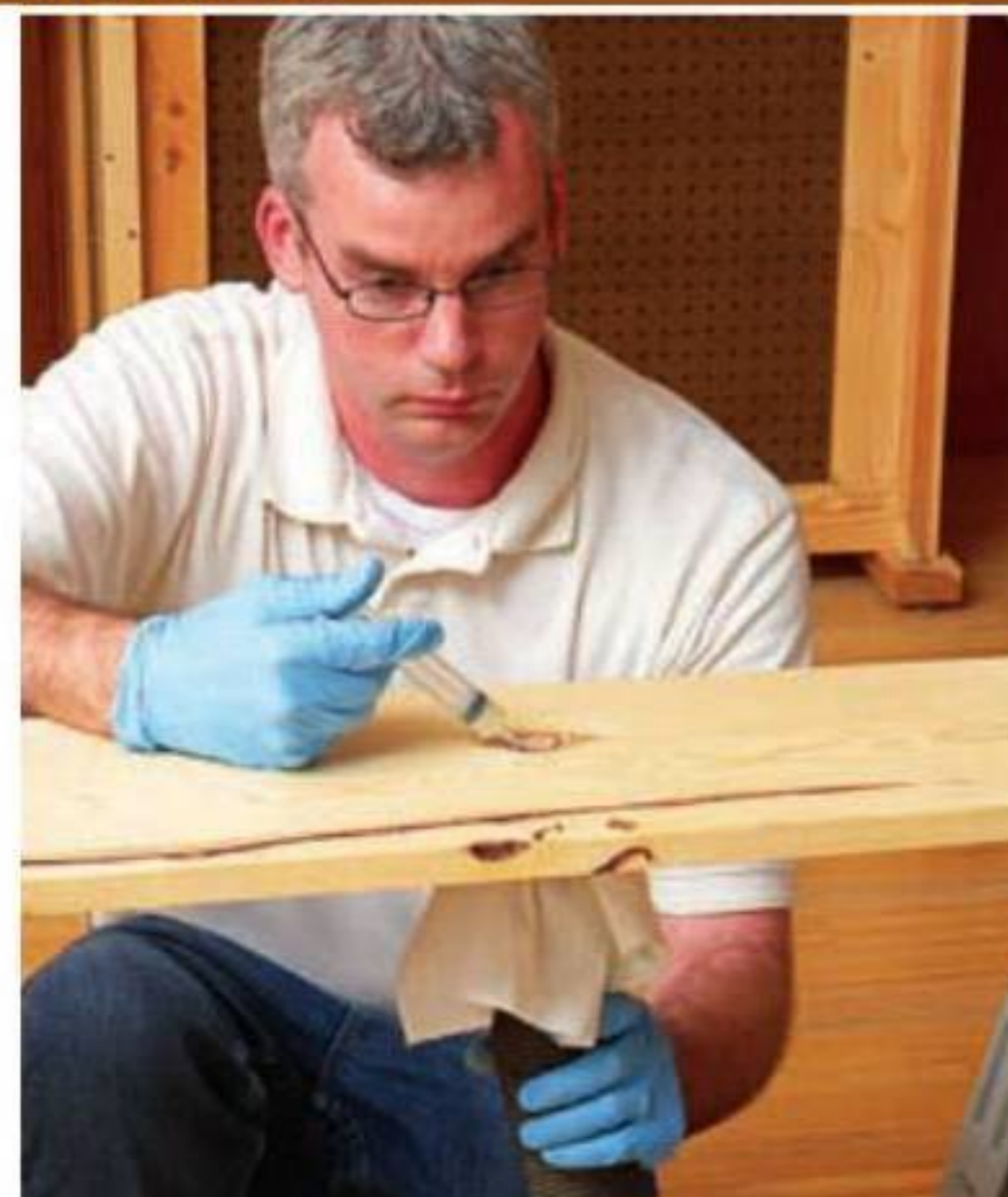
Чтобы клей проник в зазоры глубже, используйте пылесос. Защитите конец шланга бумажной салфеткой, закрепив ее резинкой.
