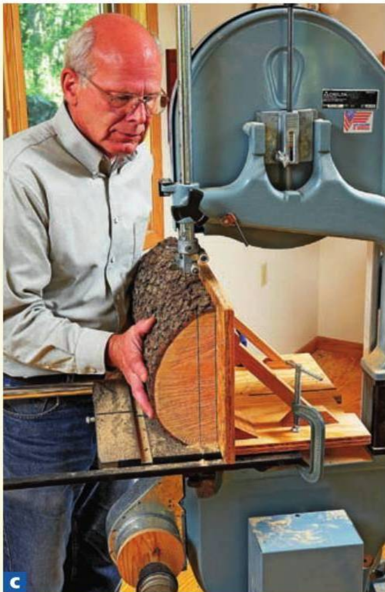
С ХОРОШИЙ УПОР ПОМОЖЕТ ПОЛУЧИТЬ ХОРОШИЕ ДОСКИ Разобрав приспособление, Брайен прикрепил вертикальную плиту к пильному столику. Возможно, ее придется установить под углом, чтобы компенсировать дрейф.
