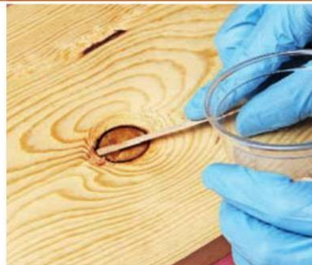
Оставшимся эпоксидным клеем заполните все неплотности. Когда клей затвердеет, доску можно обрабатывать, как обычно.
