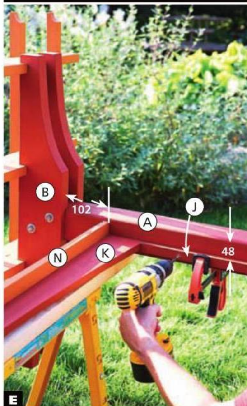
Удерживая первую раму J/K/L/M/N с помощью струбцин, прикрепите стойки J шурупами к столбам А.
