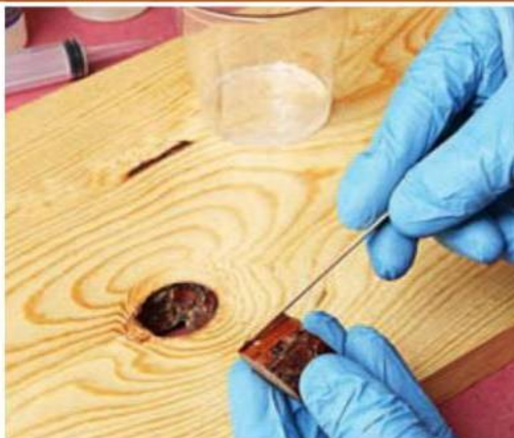
Смешав немного эпоксидного клея, обильно нанесите его на сучок и снова вставьте сучок в отверстие.
