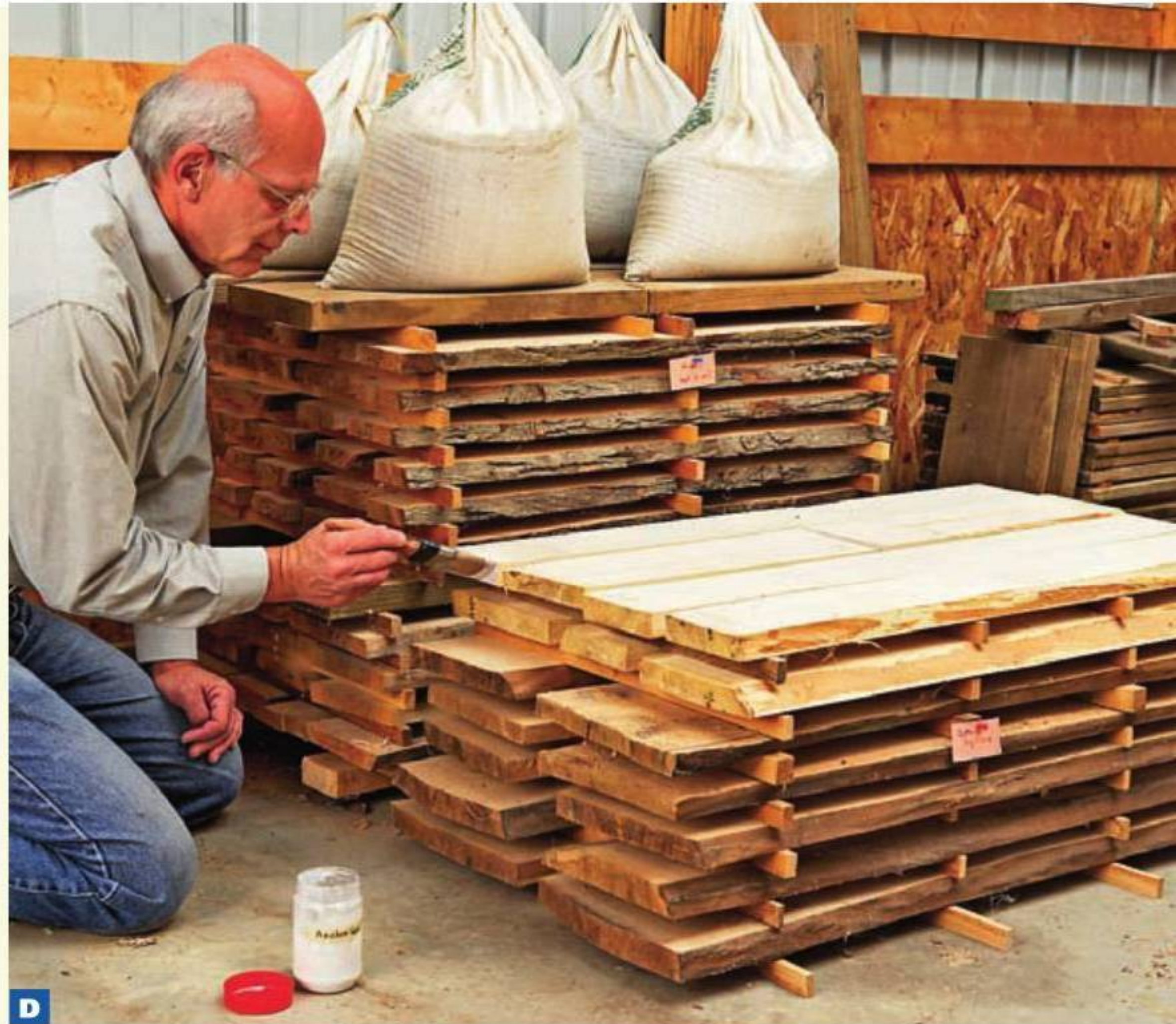
Д ЗАМАЗАВ ТОРЦЫ, УЛОЖИТЕ ДОСКИ В ШТАБЕЛЬ Древесина будет высыхать медленнее и более равномерно, если закупорить поры на торцах досок клеем, краской или специальным герметиком. Это уменьшит риск образования трещин. Выравнивайте прокладки одну над другой, чтобы через них нагрузка от верхних досок передавалась на пол, и нижние доски оставались прямыми.
