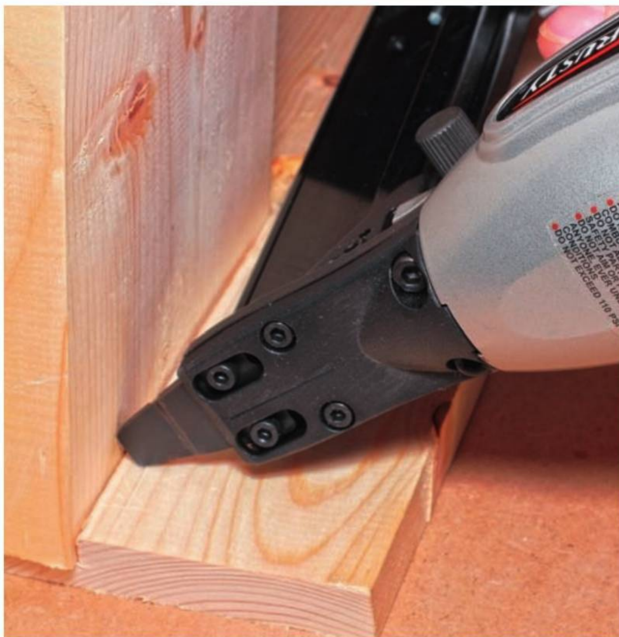
Потребность в длинных струбцинах уменьшится, если фиксировать полки в пазах с помощью гвоздей. Таким способом можно за один прием собрать корпус, не дожидаясь высыхания клея.
