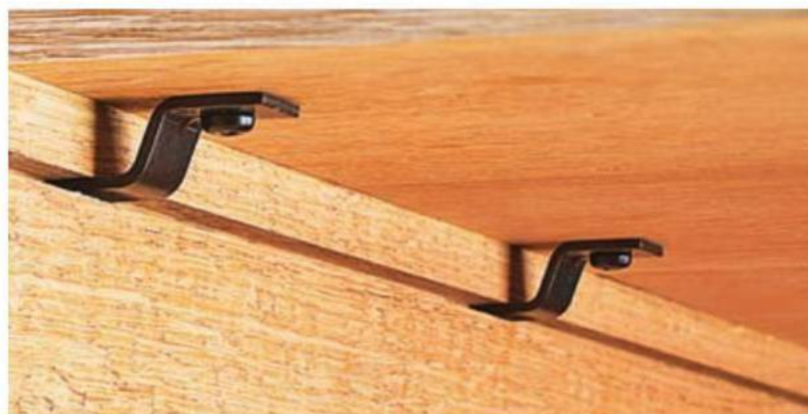
Специальные клипсы надежно удерживают крышку стола, но могут двигаться в узком пропилах, не мешая деревянному щиту сжиматься и расширяться в поперечном направлении.
