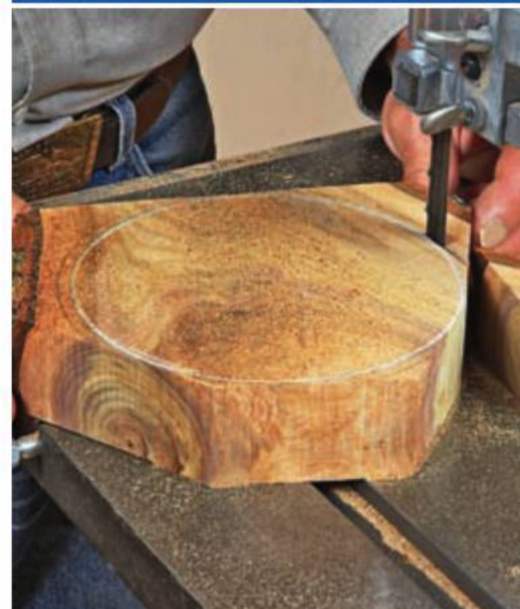
Настроив ленточную пилу для роспуска, не меняйте полотно, а выпиливайте небольшие диски с помощью коротких прямых распилов. Отпилите углы, чтобы приблизиться к линии разметки.
