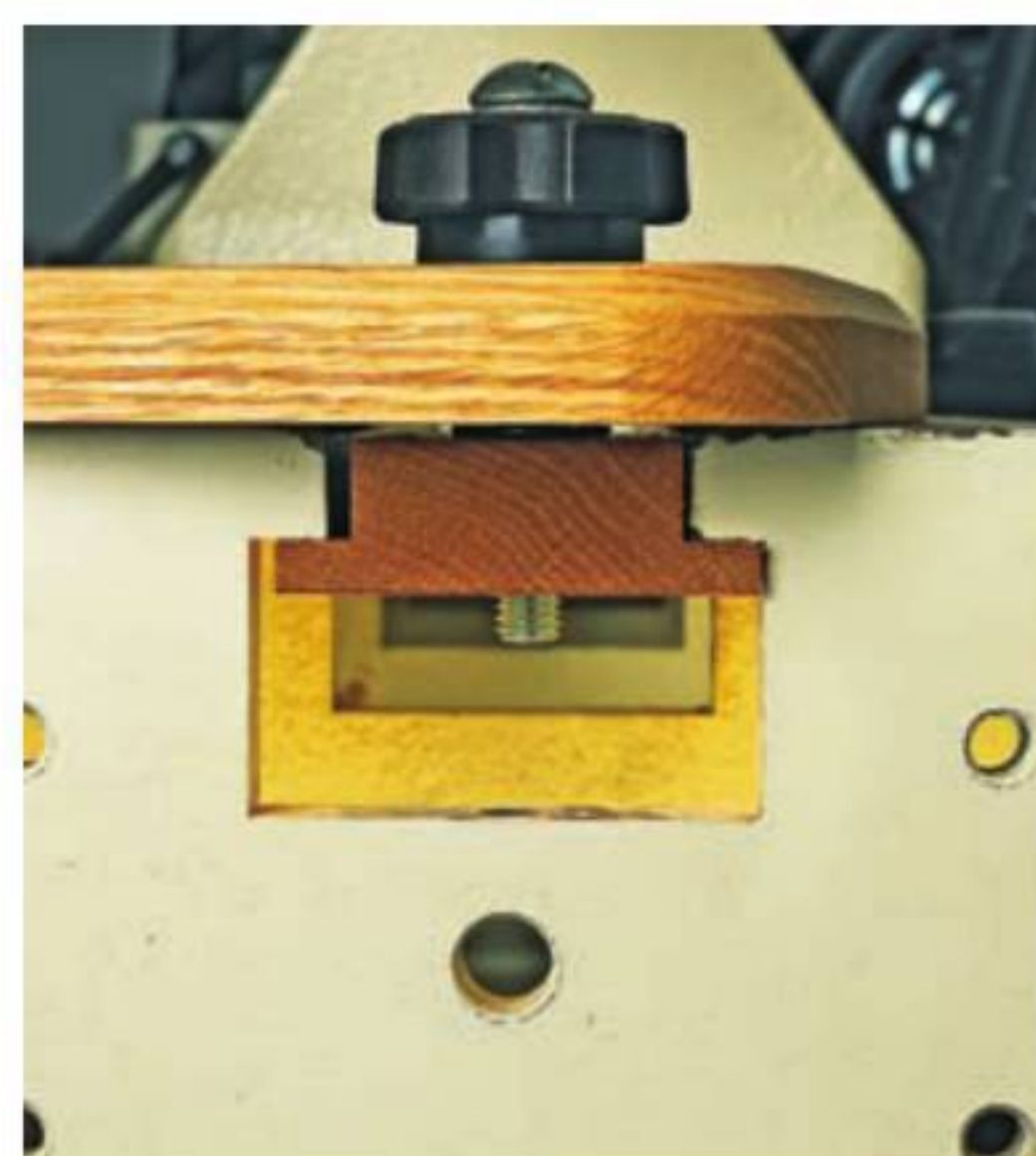
Затяните гайку-маховичок, чтобы зафиксировать положение держателя на станине станка.
